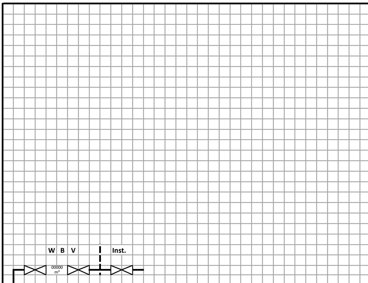
Im Versorgungsgebiet des WBV sind Einzelabsicherungen sowie ein Druckminderer hinter der Zählertraverse vorgeschrieben und somit vom Installateur zu installieren.
